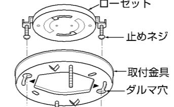
取付金具の矢印(◀▶)を止めねじに合わせて締め付ける。
