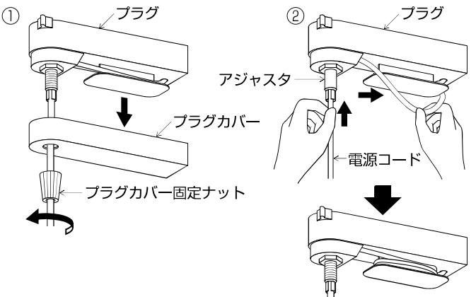
③ 微調整する場合、プラグカバーをプラグまで押し上げ、プラグカバーを押さえながら電源コードを押し込む。
