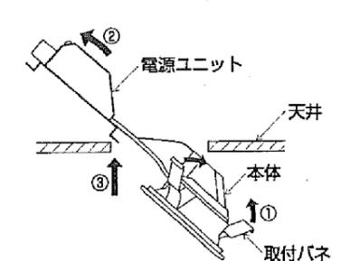
※天井材厚が薄い場合、天井との間に隙間が空くことがありますので、この場合は一度パネを押し広げてから埋込穴に挿入してください。
