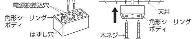
■取付手順 △注意 取付けの際は必ず電源を切ってください。感電の原因になります。
