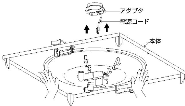
※本体の取付けは<埋込ローゼットの場合>、<その他の配線器具の場合>をご覧ください。<その他の配線器具の場合>で2段階押し上がりにくい場合は、本体の中央付近を押して、確実に取付けてください。
