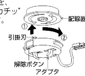
△警告 解除ボタンを押さずに左に回し、はすれないと音がするまで右に回す。アダプタの取付けが不完全な場合、落下によるけがの原因になります。
