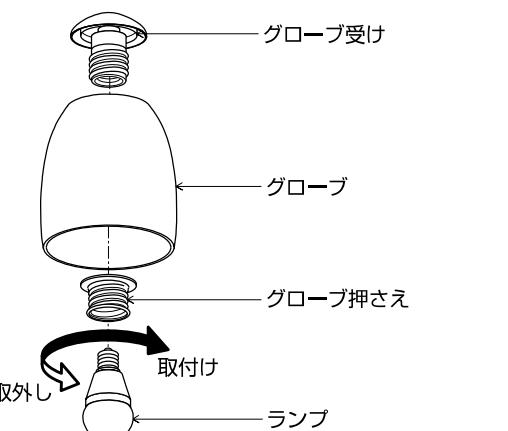
■ランプ交換について △注意 ランプ交換の際は安全のため電源を切ってください。感電の原因になります。
