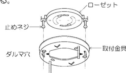
取付金具の矢印(◀▶)を止めネジに合わせて締め付ける。
