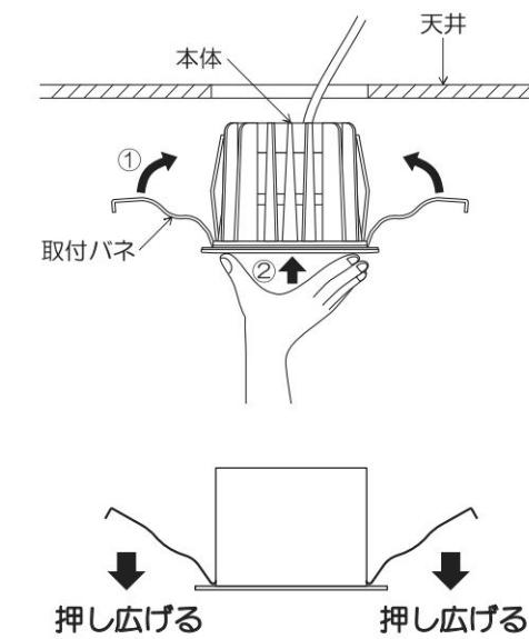
※天井材厚が薄い場合、天井との間にすきまが空くことがありますので、この場合は一度バネを押し広げてから埋込穴に挿入してください。
