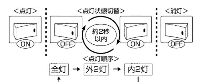
■リモコンで操作する ※壁スイッチがある場合、壁スイッチをONにし、リモコン送信機を操作してください。
