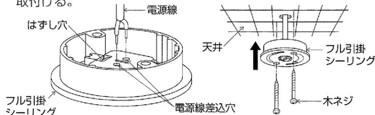
※目透かし天井に取付ける場合は、目印を目透かし方向に合わせて取付ける。
