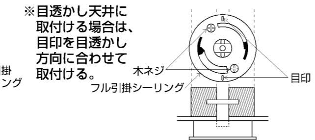
■取付手順 △注意 取付けの際は必ず電源を切ってください。感電の原因になります。
