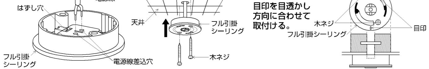
※目透かし天井に取付ける場合は、目印を目透かし方向に合わせて取付ける。木ネジ フル引掛けシーリング
