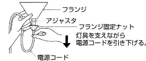
※電源コードの調整が固い場合は、一旦、フランジ固定ナットをアジャスタから取外し、もう一度2回転程締め付け、仮止めしてください。
