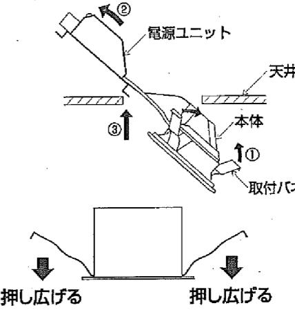
※天井材厚が薄い場合、天井との間に隙間が空くことがありますので、この場合は一度バネを押し広げてから埋込穴に挿入してください。
