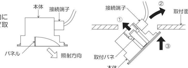
※天井材厚が薄い場合、天井との間にすきまが空くことがありますので、この場合は一度バネを押し広げてから埋込穴に挿入してください。
