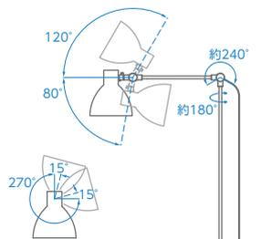
アームと灯具、それぞれの可動の組み合わせにより設置条件に幅広く対応した配光の振り分けを可能にします。
