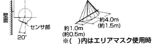
●センサを動かして感知エリアを調整できます。
