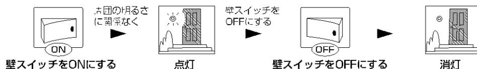
※電源投入後、約20秒間点灯し、その後約40秒間は明るくても人を感じることにより約5秒間点灯します。電源投入から約60秒後に一旦消灯し設定したモードになります。(連続点灯モードを除く。)
