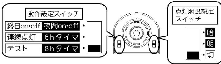
① 電源投入後、約20秒間点灯し、その後は明るくても人を感知するごとに約5秒間点灯します。結線および負荷の作動を確認できます。
