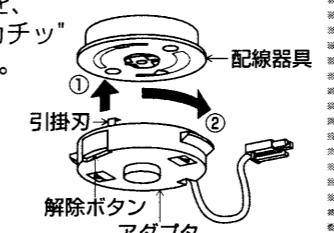
△警告 解除ボタンを押さずに左に回し、はずれないことを確認してください。アダプタの取付けが不完全な場合、落下によるけがの原因になります。
