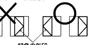
△警告 緑色の矢印の先端が両端にくるまで本体を押し上げてください。取付けが不完全な場合、落下によるけがの原因になります。
