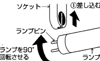
ランプピンをソケットに確実に差し込み、90°回転させて取付ける。
