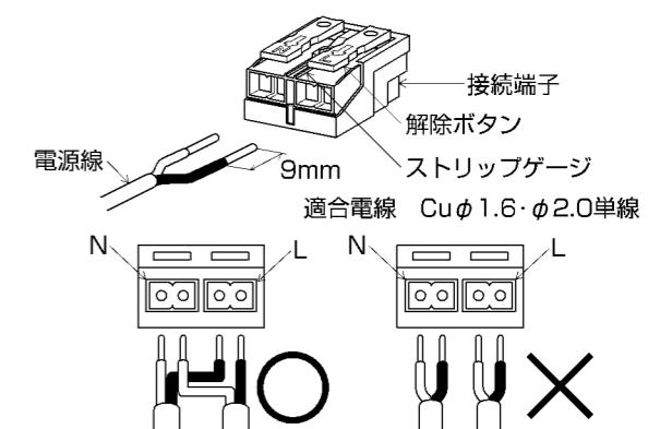
電源接続をする際は壁スイッチを必ず設ける。
