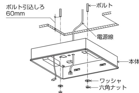
※六角ナットの締付トルクは1.0N・m以下です。締付トルクが適正値を超えると、器具変形・天井面とのすきまの原因になります。すきまを確認しながら締め付けを調整してください。
