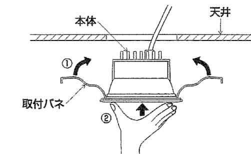
※天井材厚が薄い場合、天井との間にすきまが空くことがありますので、この場合は一度バネを押し広げてから埋込穴に挿入してください。
