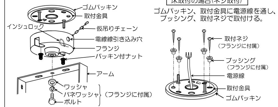
③フランジの仮吊りチェーンを取付金具の仮吊りチェーン引掛穴に引掛ける。
