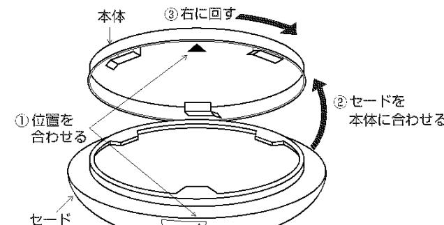
△警告 セードが確実に取付いたことを確認してください。取付けが不完全な場合、落下によるけがの原因になります。
