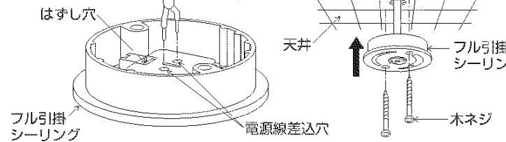
※目透かし天井に取付ける場合は、目印を目透かし方向に合わせて取付ける。
