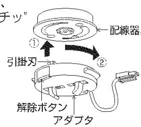
△警告 解除ボタンを押さずに左に回し、はすれないことを確認してください。アダプタの取付けが不完全な場合、落下によるけがの原因になります。
