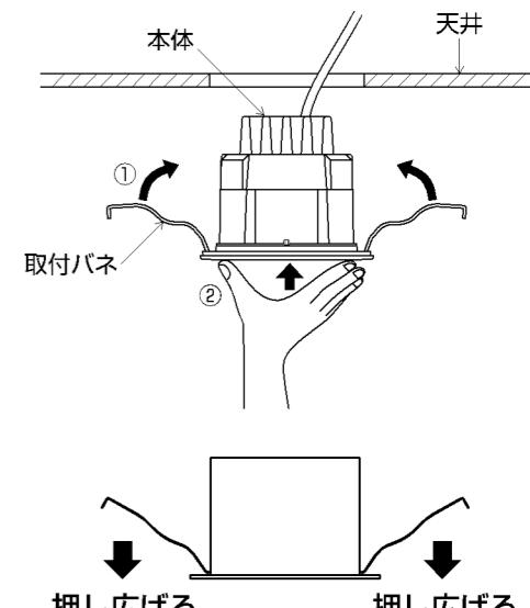
※天井材厚が薄い場合、天井との間にすきまが空くことがありますので、この場合は一度バネを押し広げてから埋込穴に挿入してください。
