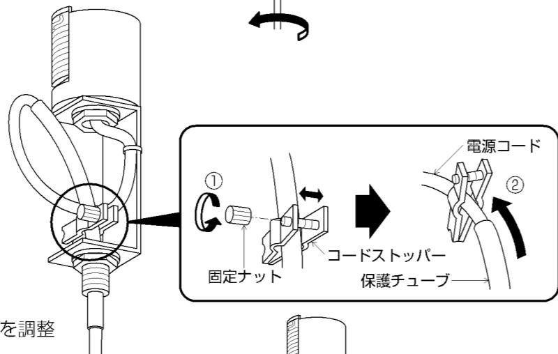
③保護チューブを持って、電源コードの長さを調整する。
