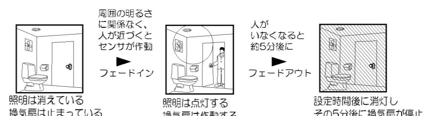
※電源投入後、約30秒間点灯し、その後約30秒間に明るくても人を感知するごとに約10秒間点灯します。
