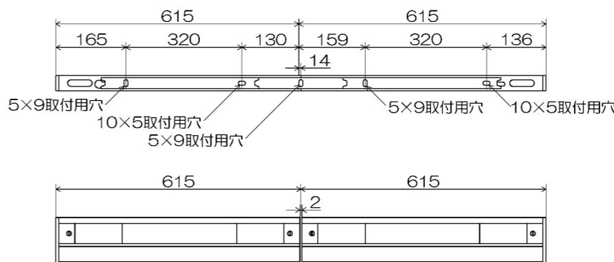
■施工手順(単体取付の場合) △注意 取付けの際は必ず電源を切ってください。感電の原因になります。
