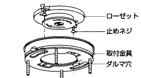
取付金具を回転させ、止めねじを締め付けて取付ける。
