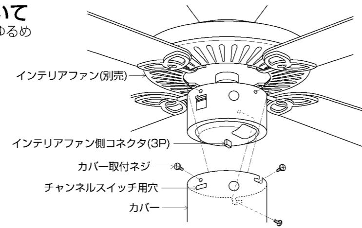
取外したカバー取付ネジのうち2本をインテリアファンに仮止めする。
