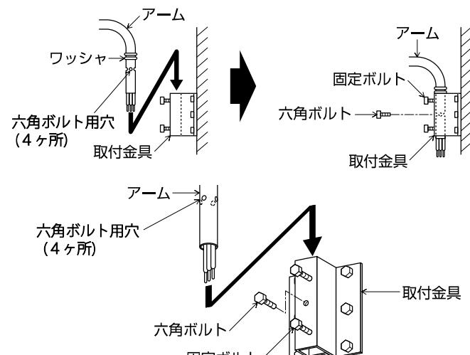
アームの固定は取付金具に対して90°間隔で4方向への取付けが可能です。
