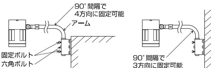
※アームの六角ボルト用穴は、六角ボルトに対して少し余裕がある為、取付面から90°にならない場合があります。その場合は、アームの向きを90°に調節してから、固定ボルト(2ヶ)で確実に締め込んでください。
