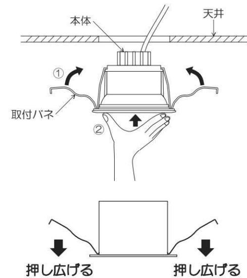
※天井材厚が薄い場合、天井との間にすきまが空くことがありますので、この場合は一度バネを押し広げてから埋込穴に挿入してください。
