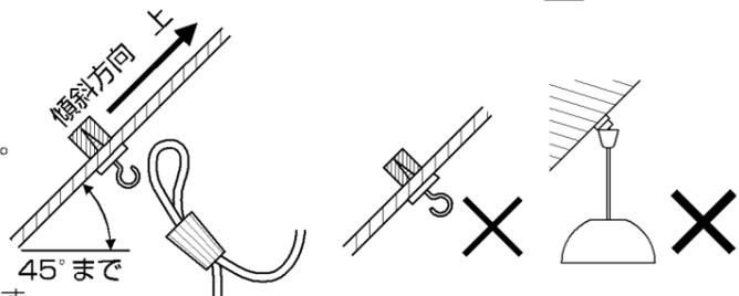
△警告 ベニヤ板などの強度の弱い場所には取付けしないでください。落下によるけがの原因になります。
