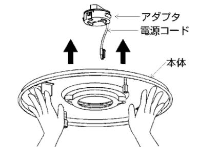
※本体取付けの際、アダプタの解除レバーの方向と固定ナットの方向を合わせてください。
