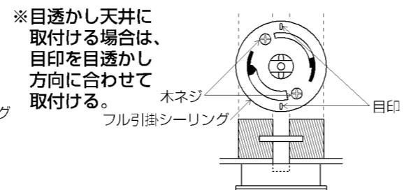
■取付手順 △注意 取付けの際は必ず電源を切ってください。感電の原因になります。
