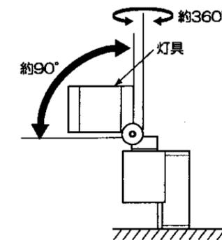
※灯具固定ネジがゆるみ、灯具が固定できなくなった場合は、六角レンチ(別途)で灯具固定ネジを締め付けてください。
