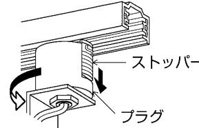
△警告 プラグのストッパーを操作する際は慎重に行ってください。プラグが損傷しますと火災・落下によるけがの原因になります。
