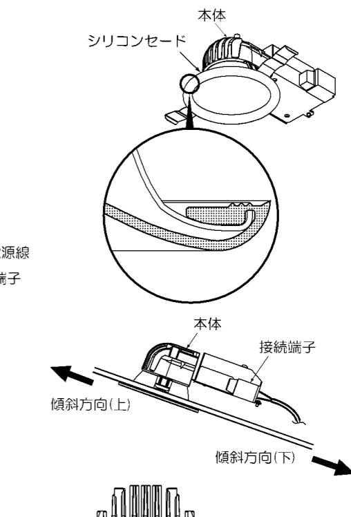
※天井材厚が薄い場合、天井との間に隙間が空くことがありますので、この場合は一度バネを押し広げてから埋込穴に挿入してください。
