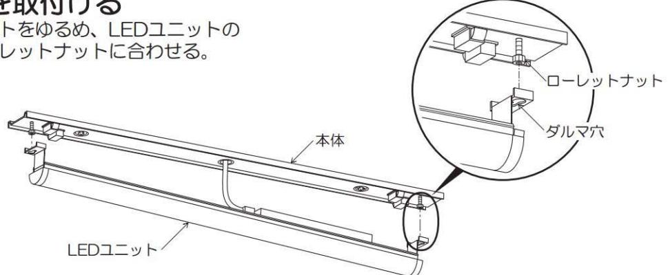
LEDユニットを回転させ、ローレットナットを締め付けて取付ける。
