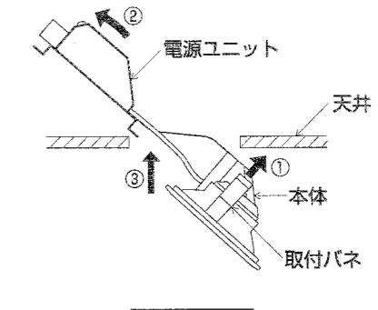
\*天井材厚が薄い場合、天井との間にすきまが空くことがありますので、この場合は一度バネを押し広げてから埋込穴に挿入してください。
