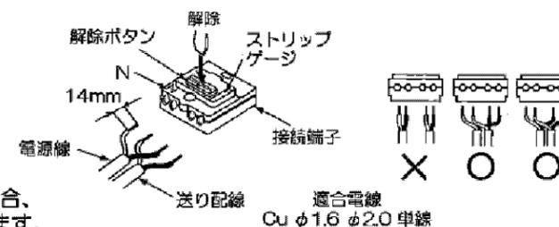
△警告 電源の接続は確実に行ってください。接続が不完全な場合や電源線が器具に接触した場合、容量オーバーした場合は火災・感電の原因になります。
