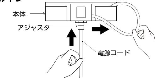
②押し込んだ電源コードを本体側面で束ね、コード押さえに引っ掛ける。
