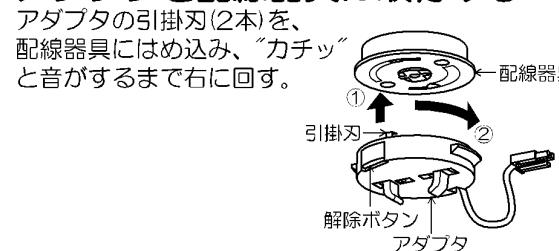
△警告 解除ボタンを押さずに左に回し、はずれないことを確認してください。アダプタの取付けが不完全な場合、落下によるけがの原因になります。
