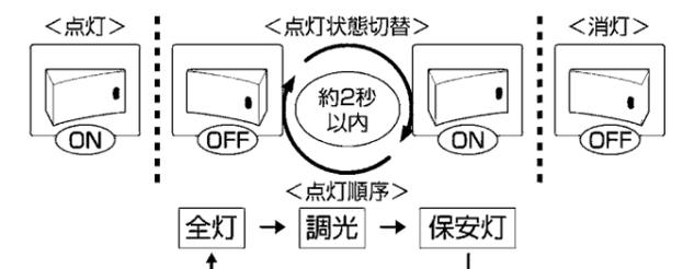
■リモコンで操作する ※壁スイッチがある場合、壁スイッチをONにし、リモコン送信機を操作してください。
