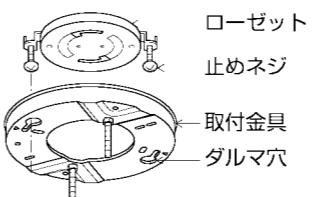
取付金具の矢印(▶◀)を止めネジに合わせて締め付ける。
