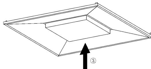
※片側の固定バネのみでLEDユニットが引き上げられた状態ではLEDユニットを正常に取付けられません。
