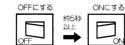
壁スイッチをOFFにし、しばらく(約5秒以上)してからONにすると、約30秒点灯してから、設定モードになります。60秒間は点灯照度設定にかかります。人体感知の場合点灯します。
