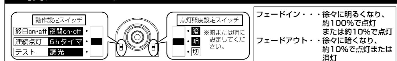
暗くなつと6時間約10%で自動点灯し、その後は、人が來た時だけ約100%で点灯
