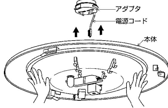
※本体の取付けは<埋込ローゼットの場合>、<その他の配線器具の場合>をご覧ください。<その他の配線器具の場合>で2段階押し上がりにくい場合は、本体の中央付近を押して、確実に取付けてください。
