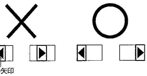
△警告 緑の先端が両端にくるまで本体を押し上げてください。取付けが不完全な場合、落下によるけがの原因になります。
