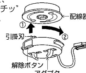
△警告 解除ボタンを押さずに左に回し、はすればないことを確認してください。アダプタの取付けが不完全な場合、落下によるけがの原因になります。
