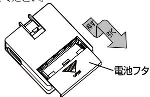
②単3形アルカリ乾電池を表示に合わせて極性を間違えないように入れて、電池フタを締めてください。
