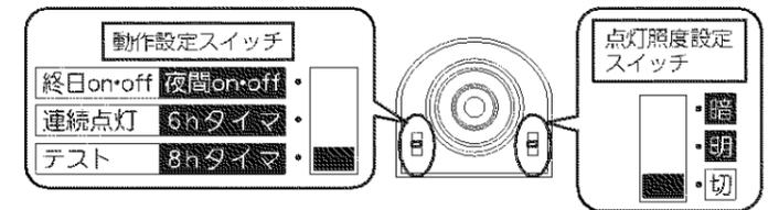
①電源投入後、約20秒間点灯し、その後は明るくても人を感じることにより約5秒間点灯します。結線および負荷の作動を確認できます。
