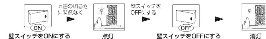
※電源投入後、約20秒間点灯し、その後約40秒間は明るくても人を感知するごとに約5秒間点灯します。電源投入から約60秒後に一旦消灯し設定したモードになります。(連続点灯モードを除く。)
